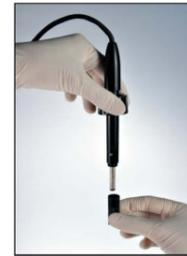
3 - Inserire il cappuccio sul sensore, facendo attenzione che non rimanga aria all'interno. Pulire l'eccesso di elettrolita con carta assorbente. Il sensore è pronto.
