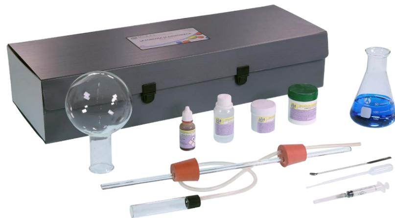
Questo esperimento rappresenta un classico del laboratorio didattico. L'ammoniaca prodotta per reazione chimica, viene utilizzata in un secondo processo che produce energia meccanica, creando uno zampillo di acqua e particolari effetti cromatici. L'ammoniaca gassosa necessaria viene prodotta per reazione chimica e convogliata nell'apparecchio. L'esperimento può essere ripetuto numerose volte.
