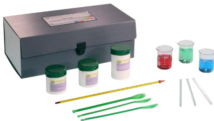
Con il kit proposto è possibile misurare gli effetti del calore scambiato durante le reazioni chimiche. Tre sono le metodiche proposte e relative alle reazioni eso, endo e atermiche. La confezione contiene materiali per eseguire più volte gli esperimenti descritti.
