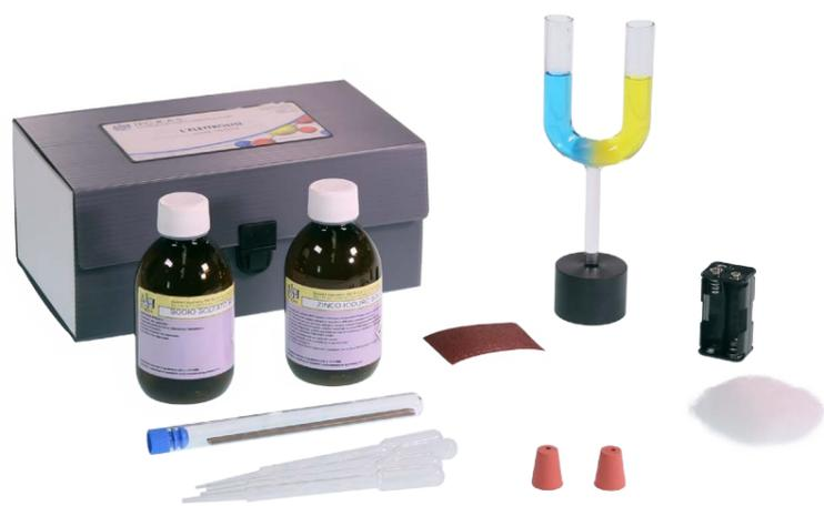
Il passaggio della corrente elettrica nella soluzione contenuta nel tubo di vetro, provoca reazioni chimiche evidenziate dalla comparsa di particolari colorazioni. La cella è alimentata a pile. La confezione contiene materiali per eseguire più volte le due metodiche descritte.
