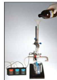
13 - Effettuare un lavaggio della buretta, introducendo, con l'ausilio dell'imbuto, pochi ml di soluzione di sodio idrossido 0,1 N.
