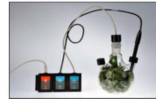
4 - Riempire parzialmente la camera di reazione con le foglie verdi. Le foglie vanno ricise dalla pianta poco prima dell'esperimento. Chiudere la camera e posizionare i sensori di ossigeno e anidride carbonica. Collegare all'interfaccia e al PC. Avviare il programma NeuLog.
