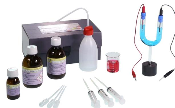
Il kit permette di visualizzare il movimento degli ioni di una soluzione sotto l'effetto di un campo elettrico. Si utilizzano ioni colorati che dal fondo del tubo ad U migrano verso gli elettrodi di platino collegati ad un alimentatore di corrente continua. Tempo medio per la migrazione 20-30 minuti.
