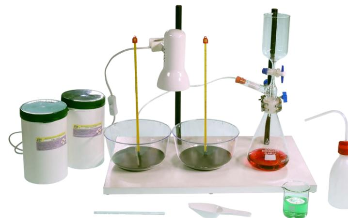
10.032 L'esperimento proposto permette di visualizzare l'effetto serra prodotto dall'anidride carbonica. In uno dei due contenitori viene immessa anidride carbonica prodotta per reazione chimica e si osserva il conseguente innalzamento di temperatura. Il kit contiene l'apparecchio completo di lampada, generatore di anidride carbonica, reattivi e istruzioni in italiano.
