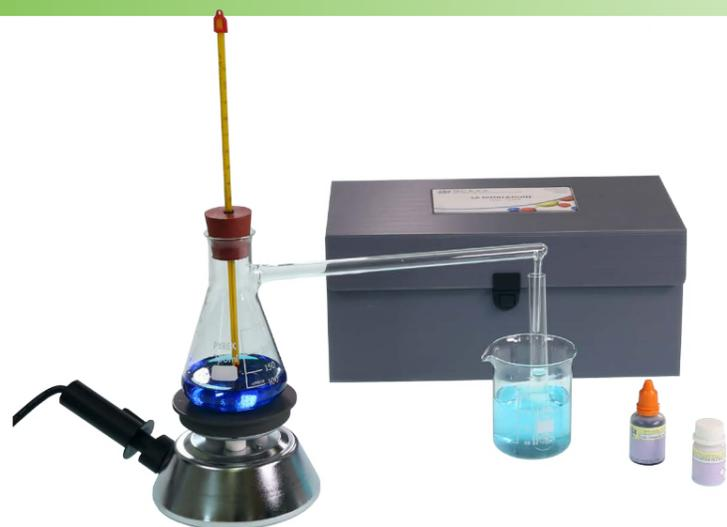
Con questo semplice distillatore è possibile separare sostanze diverse ed osservare i passaggi di stato coinvolti. Nella metodica viene preparata una soluzione colorata per la distillazione e si ottiene in pochi minuti, un campione di acqua distillata limpida. La confezione contiene materiali per eseguire più volte la metodica descritta.
