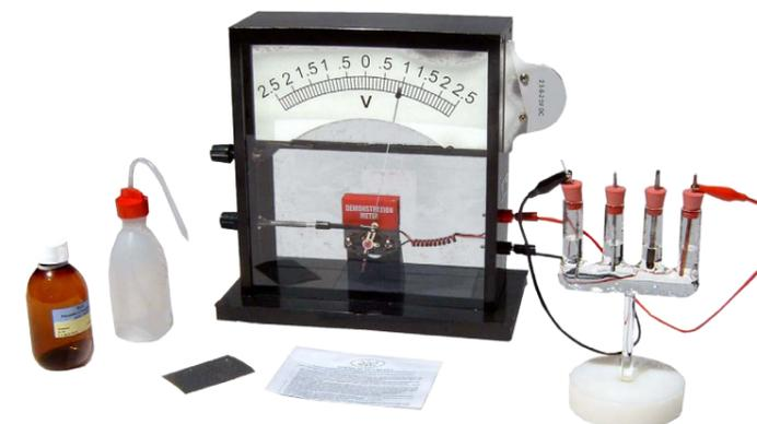
Il kit mette a confronto elettrodi di materiale diverso utilizzati all'interno di un circuito elettrico per costituire semplici pile. Attraverso l'utilizzo di un voltmetro da dimostrazione di grandi dimensioni, la metodica proposta permette di visualizzare contestualmente la forza che spinge il flusso di elettroni e la direzione della corrente elettrica.
