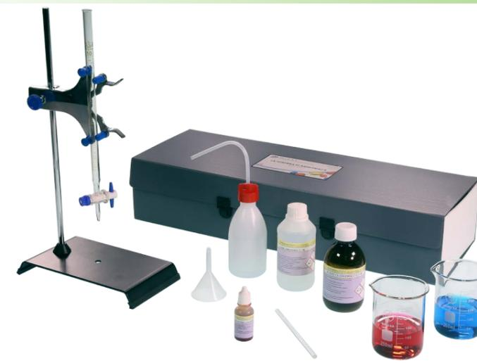
Una semplice metodica analitica permette di effettuare analisi chimiche quantitative, impiegando soluzioni a concentrazione note e indicatori di pH.
