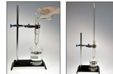
3 - Introdurre nel raccordo in vetro, la soluzione zuccherina. Posizionare il tubo graduato controllando il livello del liquido all'interno del capillare.
