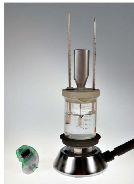
Passaggi di stato - Apparecchio per la fusione.
