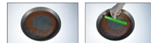
4 - La macchia dell'acido si espande allontanando la polvere. Attendere qualche secondo in modo da permettere all'etere di evaporare per ottenere un sottilissimo strato di acido oleico monomolecolare<sup>(1)</sup>. Se l'esperimento è stato ben eseguito, dovrebbe apparire una macchia circolare al centro della vaschetta. Misurare il diametro con il righello. Registrare i diametri di 3 o 4 macchie, fare la media e riportare in tabella il valore ottenuto.
