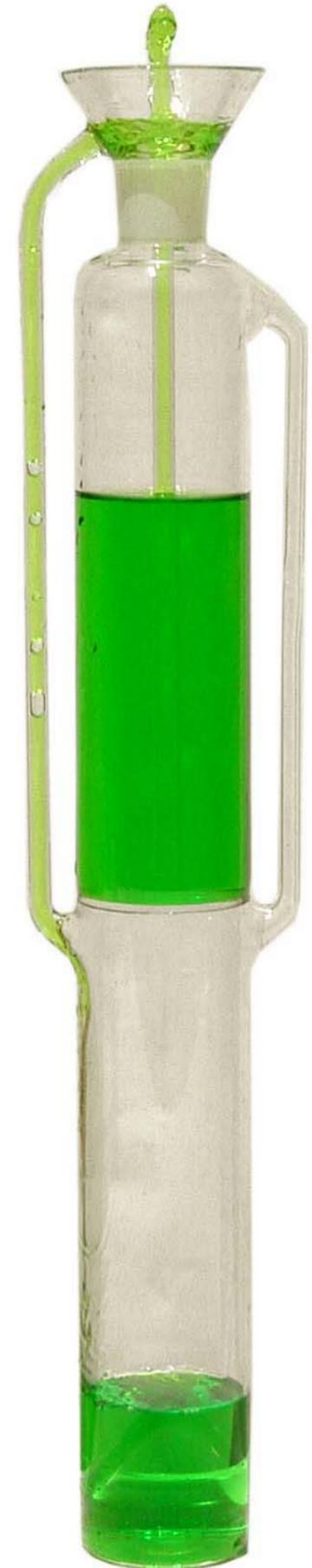
Realizzata in vetro borosilicato, dopo aver versato una piccola quantità di acqua, la fontana si innesca e produce uno zampillo costante fino a che tutta l'acqua del serbatoio superiore non si sarà trasferita in quello inferiore.
