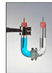
5 - Inserire un elettrodo di rame nella soluzione di rame solfato e un elettrodo di zinco nella soluzione di zinco solfato.
