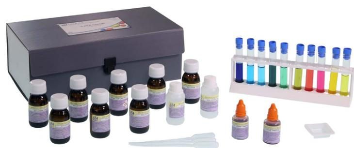
In questo kit si utilizza una miscela d'indicatori che sviluppano colorazioni diverse. Si ottiene una scala cromatica che varia dal pH 1 al pH 14. La metodica permette di effettuare la determinazione del pH in sostanze di uso comune, mediante la comparazione con la scala cromatica realizzata con i materiali in dotazione. La confezione contiene materiali per eseguire più volte gli esperimenti descritti.
