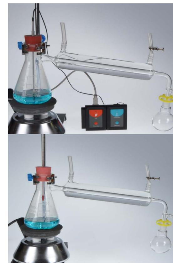
Passaggi di stato - Apparecchio per la distillazione. In alto la versione online.
