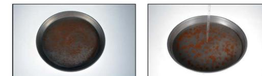
3 - Usando la propipetta e la pipetta, prelevare 0,5 ml di acido oleico 1 : 10.000 e lasciare cadere, goccia a goccia, da un'altezza di circa un centimetro 0,1 ml di soluzione sul centro della vaschetta.
