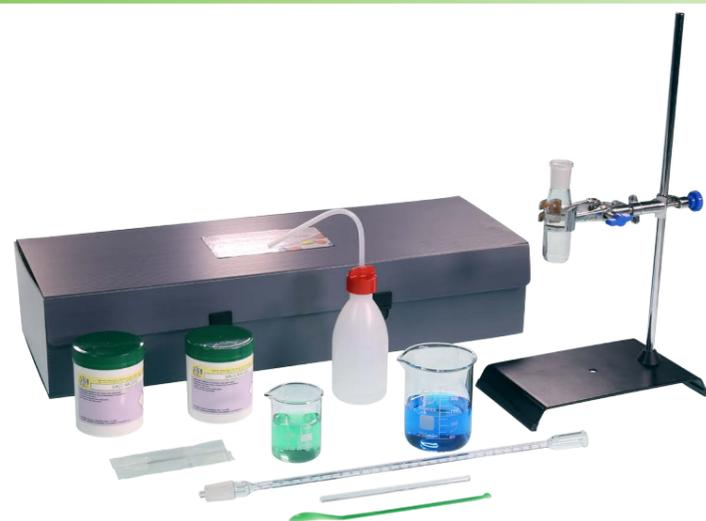
L'apparecchio proposto permette di visualizzare e misurare la pressione osmotica di una soluzione. Il tempo medio per ottenere colonne di liquido alte 30 cm è di 10-20 minuti, con soluzioni zuccherine. La velocità di risposta è molto elevata grazie alla particolare disposizione della membrana osmotica, che offre una grande superficie di scambio. L'esperimento può essere ripetuto numerose volte.
