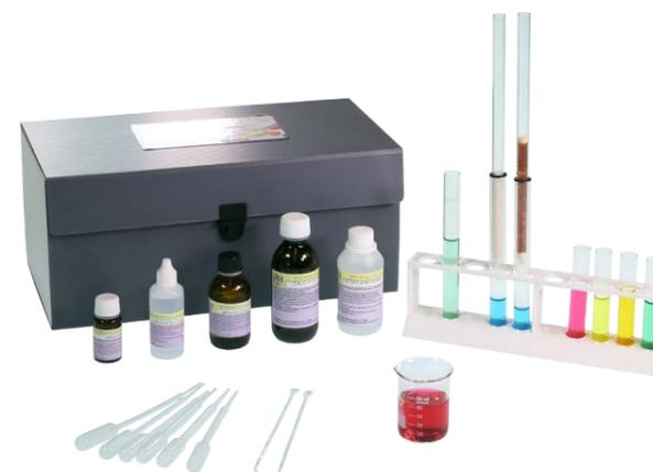
Nella metodica proposta viene eseguita la demineralizzazione di un campione di acqua, utilizzando delle resine a scambio ionico che eliminano i sali presenti. Il processo utilizzato è molto diffuso nel settore civile e industriale per la purificazione delle acque. La demineralizzazione si effettua in due stadi distinti e il kit permette con un saggio specifico di evidenziare il contenuto salino presente nelle acque naturali.
