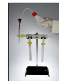
5 – Ruotare l'imbuto verso l'alto e, utilizzando la spruzzetta, eseguire un piccolo lavaggio con pochi ml di acqua.
