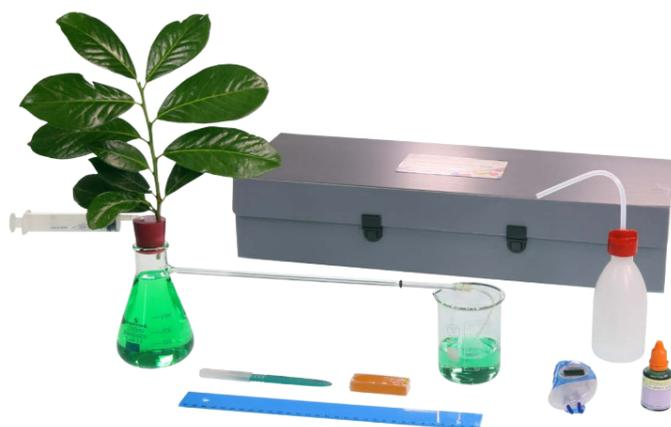
Il kit permette di misurare la velocità con cui le piante assorbono acqua per effetto della traspirazione. E' possibile osservare le variazioni causate dalle condizioni ambientali. Con una sola pianta, le misure possono essere effettuate per molti giorni. La confezione contiene materiali per eseguire numerose volte la metodica descritta.
