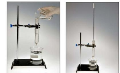
3 - Introdurre nel raccordo in vetro, la soluzione zuccherina. Posizionare il tubo graduato controllando il livello del liquido all'interno del capillare.
