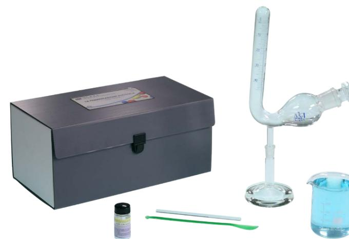
Con il kit proposto è possibile osservare il processo anaerobico con cui i microorganismi trasformano gli zuccheri in etanolo e anidride carbonica. L'anidride carbonica prodotta viene raccolta nel tubo di vetro e successivamente individuata per via chimica. La confezione contiene materiali per eseguire più volte gli esperimenti descritti. Le operazioni necessarie sono molto semplici e garantiscono la sicurezza di chi opera.
