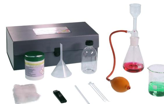
La combustione di sostanze organiche contenenti carbonio, produce principalmente acqua e anidride carbonica. L'apparecchio permette di saggiare qualitativamente il gas prodotto durante l'esperimento.
