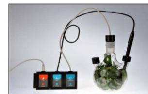
4 – Riempire parzialmente la camera di reazione con le foglie verdi. Le foglie vanno recise dalla pianta poco prima dell'esperimento. Chiudere la camera e posizionare i sensori di ossigeno e anidride carbonica. Collegare all'interfaccia e al PC. Avviare il programma NeuLog.
