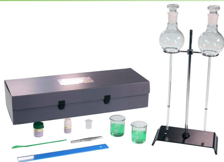
La strumentazione proposta permette di misurare l'ossigeno consumato dai tessuti vegetali durante la respirazione cellulare. La misurazione viene effettuata attraverso la variazione di volume del gas che sposta la colonna d'acqua di un tubo capillare. La doppia apparecchiatura, permette di effettuare contestualmente una prova di controllo, che compensa le variazioni di pressione atmosferica e di temperatura ambiente.
